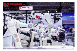
稳定性高,提高产品外观品质等。机器人焊接单元采用川崎 BA006N 焊接机器人配搭川崎焊机进行薄板焊接加工[0.6mm 镀锌板];焊接完毕后,川崎 RS020N 打磨机器人单元根据焊接轨迹进行打磨工作,使被加工产品达到达标状态。此整体单元涵盖钣金加工中的两个重要环节,既解决环境恶劣、人力资源短缺的问题,又能提高产品生产的稳定性,提升效能,提高企业的竞争力。
